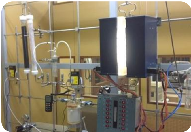
Ensayo para la eliminación de NOx mediante fotocatalisis
