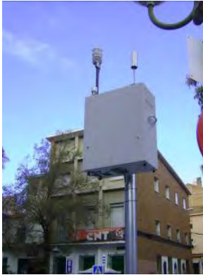
Figura 12. Analizador automático en continuo para la determinación en el aire ambiente de óxidos de nitrógeno (NO, NO 2 , NO x ) y de ozono (O 3 ) puesto en la plaza de Ágata.
