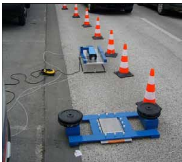
Figura 11. Ensayo "in situ" de determinación de eficiencia fotocatalítica.
