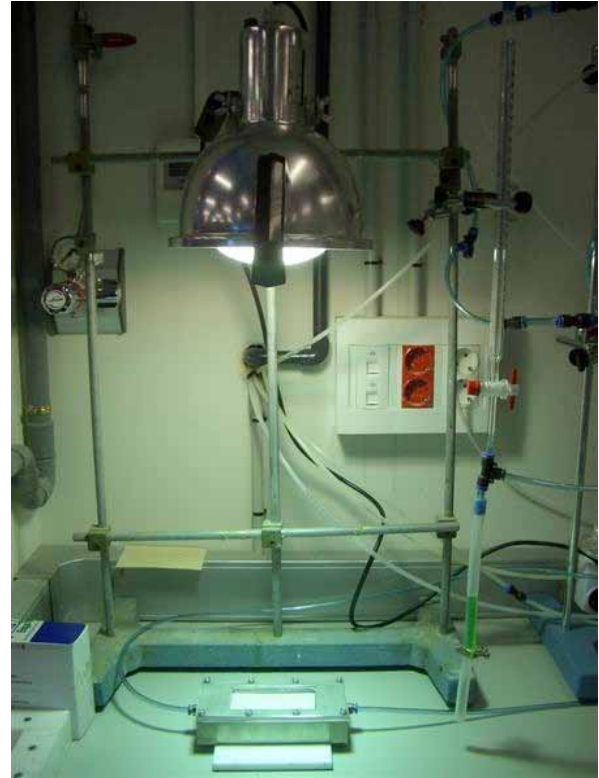
Figura 6. Cámara de ensayo de análisis de actividad fotocatalítica en laboratorio. AIDICO.
